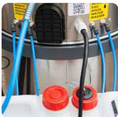
Tubo di scarico per svuotamento rapido del deposito di raccolta acqua sporca, senza dover rimuovere la testata. Motore di aspirazione tangenziale bi-stadio con effetto ciclone. Dotato di 3 pompe, caldaia, detergente, acqua. Massima sicurezza grazie ai 2 termostati di sicurezza, 1 pressostato e 1 valvola meccanica di massima pressione.
